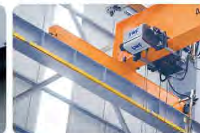
单梁桥式起重机上使用的端梁 End beam for single girder EOT crane
